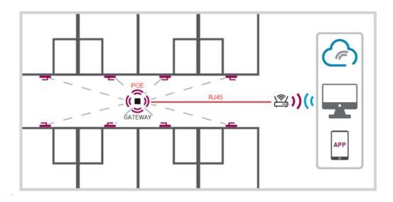
Con conexión on-line vía WiFi, las cerraduras y controles de acceso transmiten los eventos registrados a la nube, a través del Gateway, y permite gestionar los dispositivos en remoto.
